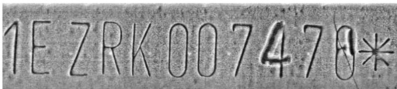
Рис. 8. МОВ фрагмента номерной площадки кузова автомобиля с фрагментами первичных номеров (...1EZRK007176), измененных методом заливки перемычек легкоплавким металлом (ЛКП не снималось)
