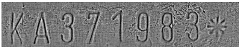
Рис. 7. МОВ фрагмента номерной площадки кузова автомобиля с фрагментами первичных номеров (...?A371097), измененных методом холодной забивки (ЛКП не снималось)
