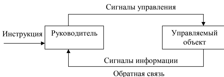
Рис. 4. Схема неавтоматического (ручного) управления объектом
