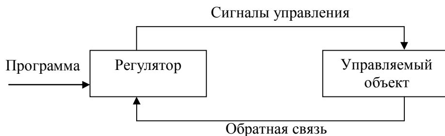
Рис. 5. Схема автоматического управления объектом
