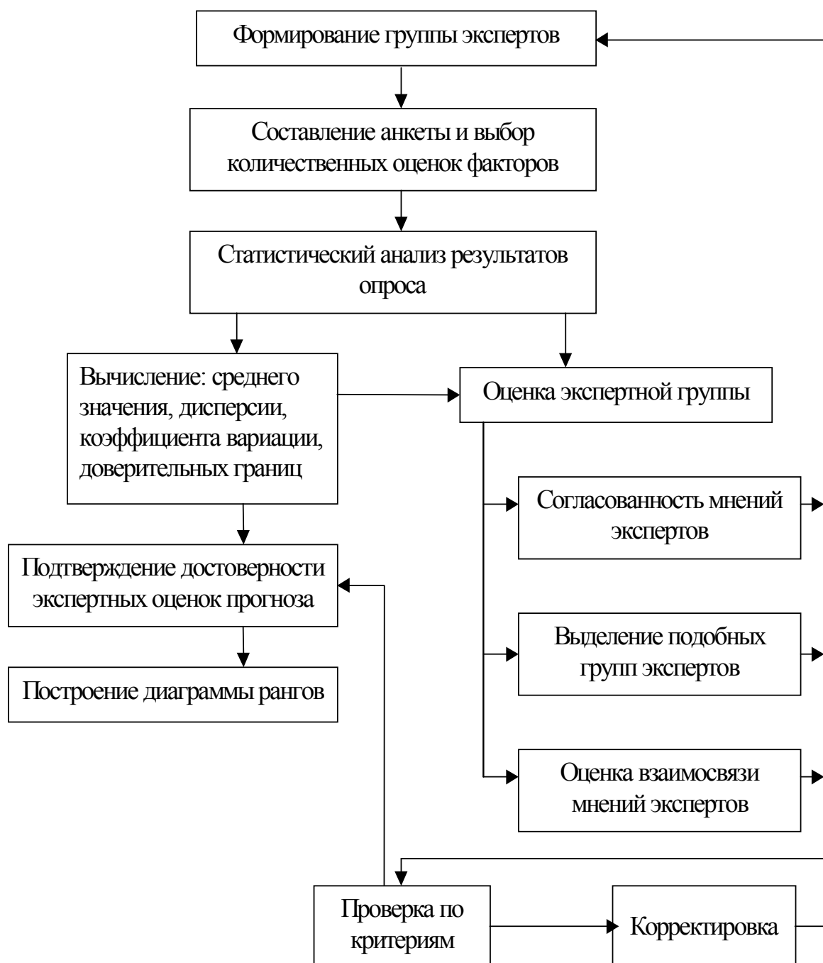
Рис. 7.7 Блок-схема прогноза на основе экспертных опросов
